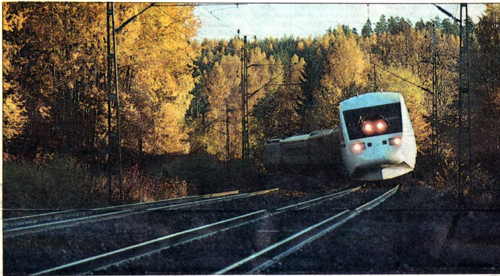
I 200 KILOMETER PER TIMME rusar snabbtåget fram genom höstlandet. Den höga farten är möjlig tack vare tågets lutning genom kurvorna.
